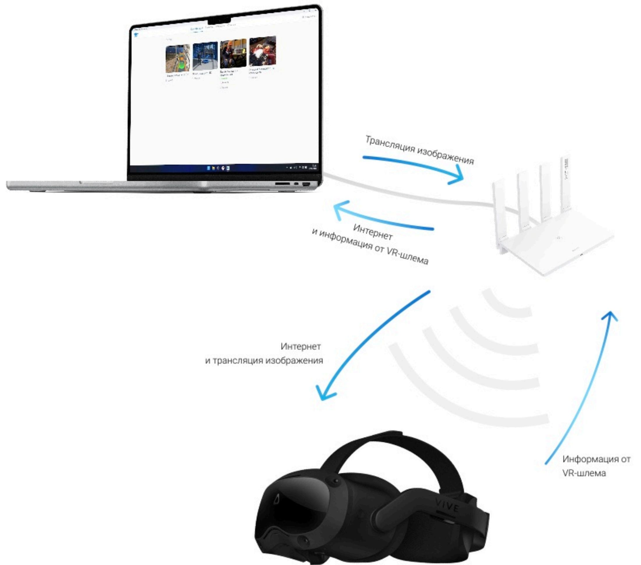
Схема подключения трансляции тренажера с компьютера на VR-шлем.
